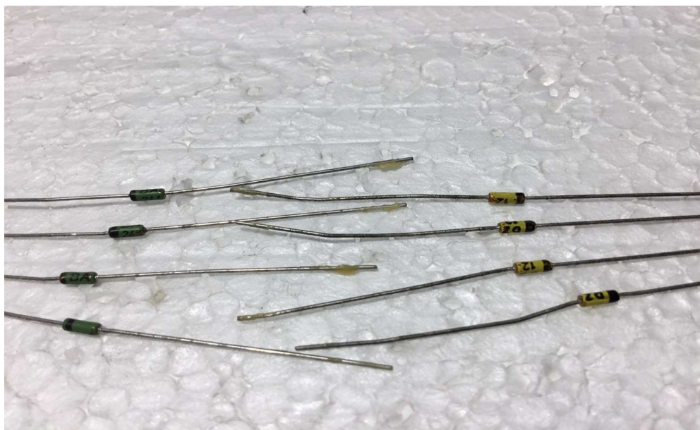
Fig. 4. DZ12 (în dreapta) diodă zener de 12 V și diode de comutație: BA244 (în stânga) – capsula D35
