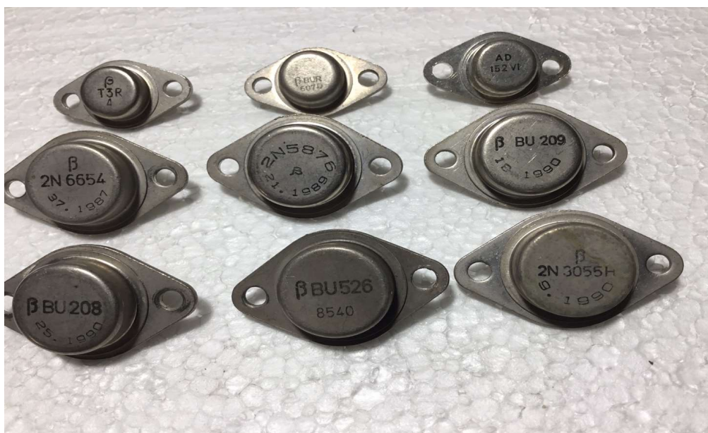
Fig. 6. Tranzistoare cu Si și Ge. În capsule TO 3 : 2N 6654, 2N 5876, BU208, BU526, 2N 3055H și rândul de sus: \beta T3R4 (tiristor; capsulă F-22), BUR 607 D tranzistor de comutație; capsulă F-22 și AD 152 VI (Ge pnp ; capsulă TO-66).
