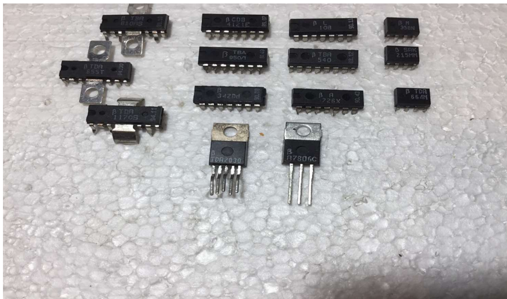
Fig. 3. Circuite integrate 1. De la stânga la dreapta. Rândul de sus : TBA 810 S - Amplificator audio 7 W -capsulă CB-155; CDB 4121 - monostabil, capsulă: MP 14 ; βL 108 – comandă LED-uri în cascadă, capsulă MP14; βM 358 Amplificator operațional dual, capsulă MP48. Rândul din mijloc: TDA 655T regulator de turație capsulă CB-155; TBA 950/1 sincroprocesor TV, capsulă TO-116; TBA 540 – circuit pentru refacerea subpurtătoarei PAL, capsulă MP117; SAK 215 MN : regulator de turație, capsulă MP-48. Rândul trei : TDA 1170 S – circuit pentru baleiajul verticală, capsulă CB-155; β 342Dd (marcaj la cerere, posibil βM 324); βA 726X - arie termostatăă de tranzistoare (TO 116); TDA 664N (nu apare în catalog, era în dezvoltare), capsulă MP48; rândul patru: TDA 2030 - amplificator audio, capsulă PENTAWAT; βA 7806C – regulator de tensiune 6 V, capsulă TO 220.
