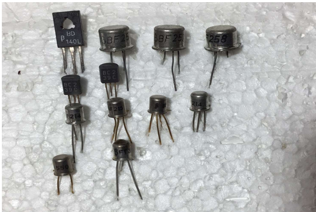
Fig. 5. Tranzistoare, rândul de sus : BD 140 L (capsula TO 126) BF 257 (2 buc.) BF 258 (capsula TO 39) rândul doi de sus: BC 239 C (capsulă TO 92) , rândul trei: BF 215; BF 200, BF 214 (2 buc) capsulă TO 72 și rândul de jos, în stânga TAA550 – capsula TO 18/2 iar în dreapta FT 2020, un fototranzistor (în partea de jos a pozei) – capsula TO 18.
