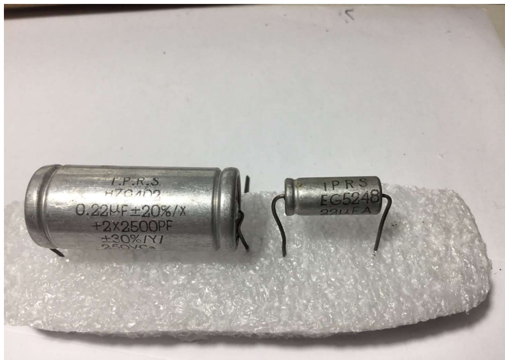
Fig. 12. Condensatori cu hârtie (în stânga) și un electrolitic (în dreapta).
