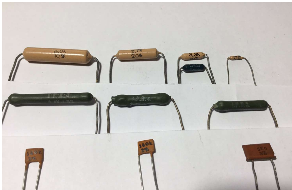
Fig. 7. Rezistențe cu peliculă de carbon de 0,25 W; 0,5 W; 1 W; 2 W (rândul de sus) și rezistențe bobinate de 3W (la mijloc) rezistențe metalice (rândul de jos).
